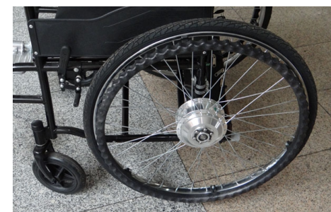
Наши мотор-колела на инвалидни колички
