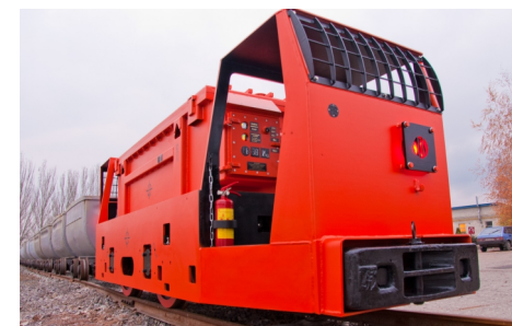
Минен електровоз ЭРА с наш двигател
